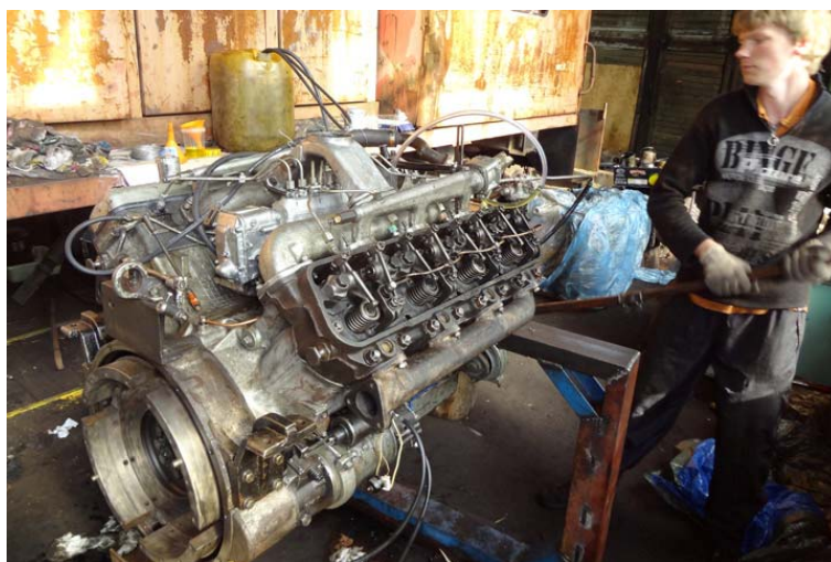
3. attēls. Dīzeļlokomotīves TU6A-1885 dīzeļdzinējs pēc remonta 2014. gada jūnijā
